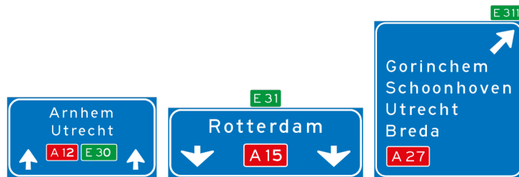
K4 高速公路上的大型决策指示牌，带有主行方向的车道面 板和出口方向的分岔面板，显示城际目的地、高速 公路路线编号及欧洲主干路线
