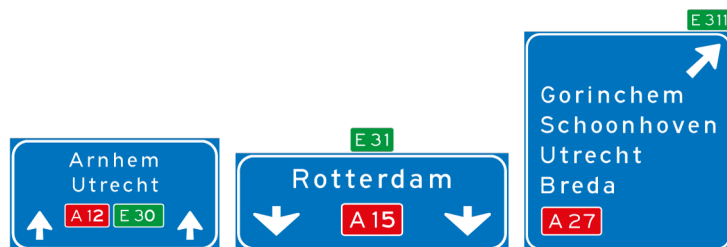
K4 Wysoka tablica decyzyjna przy autostradzie z panelem pasa ruchu dla kierunku prosto oraz panelem rozjazdu dla kierunku zjazdu, z celami międzylokalnymi, numerami tras autostrad i europejskimi trasami głównymi
