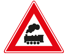
J11 Przejazd kolejowy bez zapor
